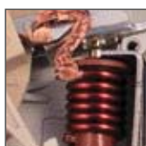
tor prądowy wykonany z wysoko gatunkowej miedzi (> 95% czystej miedzi)
