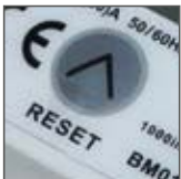
przycisk RESET do kasowania podlicznika w modelu BM01B-L
