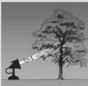
Strike offre ampia scelta di apertura del fascio luminoso: 10°, 18°, 38°, 90°.
