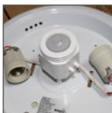
ST75: rozmieszczenie gniazda w plafonierze
