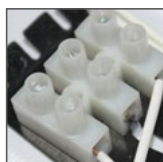
kostka przyłączeniowa dodatkowo odizolowana od obudowy
