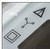
przystosowane dla sieci 4-przewodowej, wykonane w II klasie ochronności
