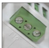
podłączenie 3-przewodowe (L, N, LO)
