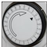
tarcza obrotowa z 96 zapadkami
