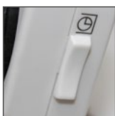
praca programatora, praca ciągła (przełącznik)
