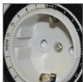
tarcza programatora na obwodzie gniazda
