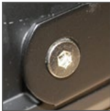
mocowanie uchwyty na śruby imbusowe
