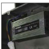
wbudowany układ zasilający
