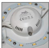
PLD: wbudowane diody LED
