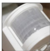
czujnik typu PIR, zakres detekcji 90°x180°
