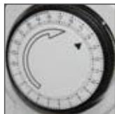
tarcza obrotowa z 96 zapadkami
