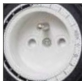
tarcza programatora na obwodzie gniazda
