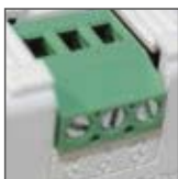
podłączenie 3-przewodowe (L, N, L 2 )
