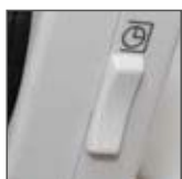
praca programatora, praca ciągła (przełącznik)
