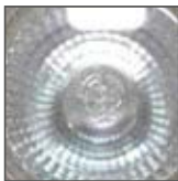
widok wnętrza lampy ze szklanym odbłyśnikiem
