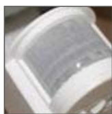
czujnik typu PIR, zakres detekcji 90°x180°
