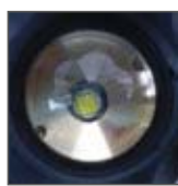
dioda CREE Q5 w modelach LB-230, LB-420
