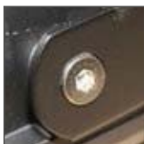
mocowanie uchwyty na śruby imbusowe
