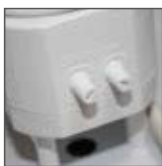
potencjometry: regulacja TIME, LUX
